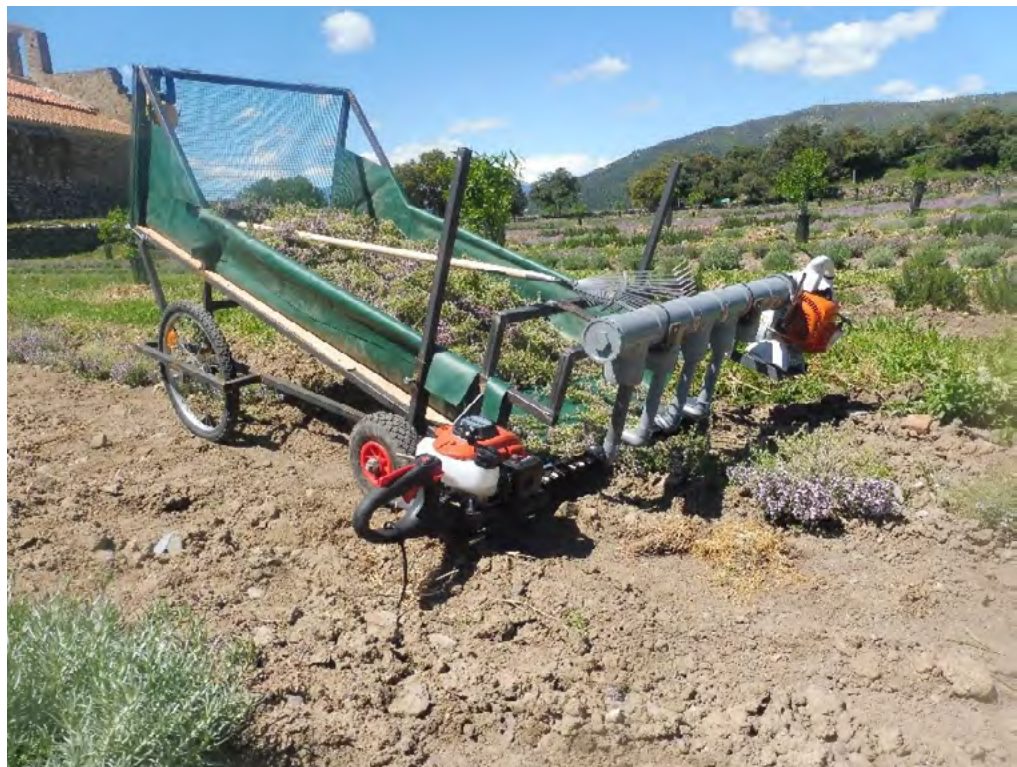
» Figure 8 : Récolteuse auto-construite par un producteur
