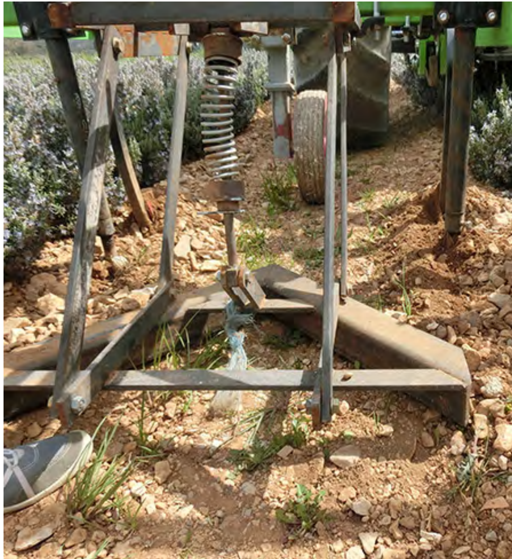
» Figure 7 : Bineuse auto-construite avec l'Atelier Paysan
