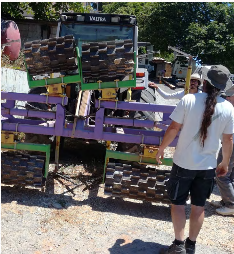
La binofaca auto-construite par Laurent (source : Laurent Bouvin)
